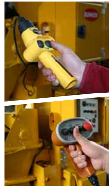
Commande à distance avec câble électrique
