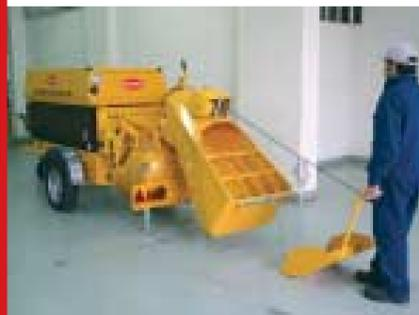
La pala raschiante facilità il carico
