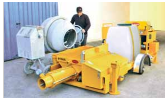
alimentata da una betoniera
