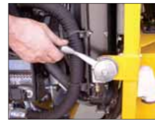
La velocità del motore Diesel è regolata da una pratica leva.
