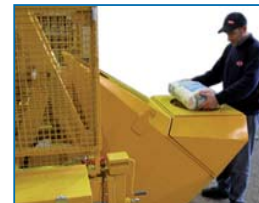
Dispositivo montado sobre a caçamba de carga para ruptura dos sacos
