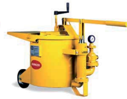
B1 Totalmente manual 6 l/min
