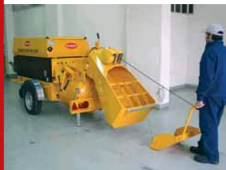
A pá raspadora facilita o carregamento
