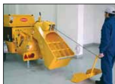
Caçamba de carga com pá raspadora
